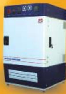
ترمیناتور مدل JTGL200 دامنه درجه حرارت -۲۰ تا +۴۵ درجه سانتی گراد
